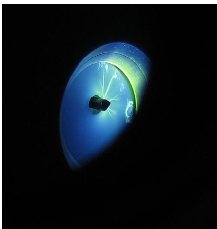
Rysunek 2. Krypton dotowany cyjanoacetylenem, poddany rozładowaniom elektrycznym i zestalony w temperaturze 8 stopni Kelvina. Niebieska luminescencja pochodzi głównie od cząsteczek C_6N_2 oraz C_3N^- powstających w następstwie dysocjacji HC_3N . [Ann. Centre Sci. APS, 9 (2010) 35]
